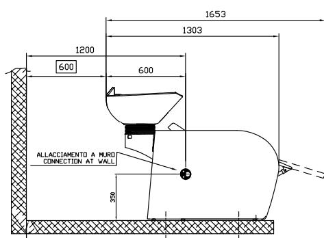
ALLACCIAIMENTO IDRAULICO A MURO
